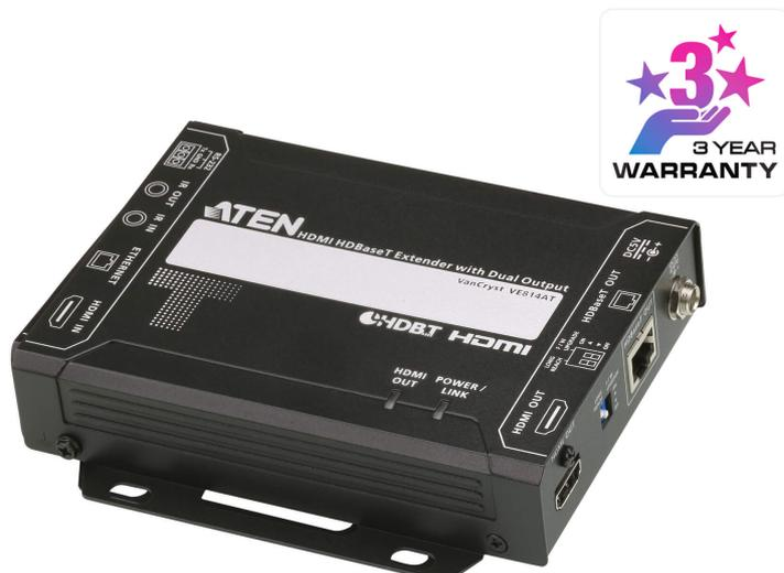
ATEN VE814AT é um Transmissor Vídeo HDBaseT capaz de enviar sinais HDMI até 100 m através de um só cabo Cat 5e/6/6a ou ATEN [2L-2910](#) Cat 6. Com saídas duplas sincronizadas, VE814AT pode transmitir sinal vídeo para dois ecrãs remotos e um local. Este transmissor HDCP 2.2 está conforme à Especificação HDMI, incluindo 3D, Deep Color, taxa máxima de dados de (10,2 Gbps), e qualidade vídeo 4K até 100 m.
