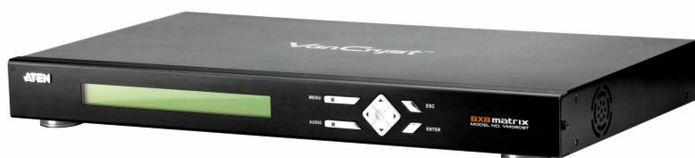
A Solução de Matriz Multimédia VanCryst™ é uma combinação do Switch de Matriz A/V VM0808T 8 x 8 Cat 5 e da Extensão A/V Sobre Cat 5 [VE500](#) / [VE300](#). O VM0808T é um Switch de Matriz que utiliza extensores [VE500/VE300](#) para rotear e distribuir sinais áudio, vídeo e RS-232 a distâncias de até 300 metros com resoluções vídeo de 1280x1024
