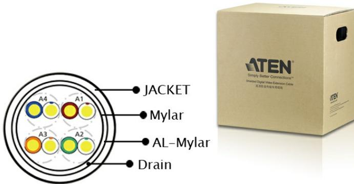
O cabo de extensão de vídeo digital encapado 2L-2901 é um cabo encapado entrelaçado com filme metálico condutor. O cabo utiliza fios de cobre muito usados para transmissões de dados. Sua camada externa metálica protege as transmissões de sinais contra interferência eletromagnética e reduz o impacto causado por ruídos elétricos. O 2L-2901 pode suportar conexões de longa distância enquanto protege a qualidade da transmissão.
