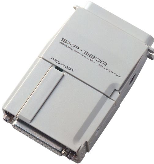
O cabo SXP320A oferece um conector paralelo e um conector serial em ambos os lados. Os usuários podem usar dispositivos com ambas interfaces e não precisarão comprar novo equipamento ou interface especial devido a diferenças de interface.
