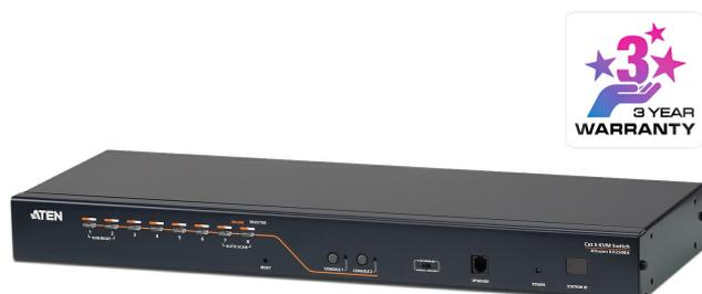
O comutador KVM KH2508A é uma unidade de controle que permite aos administradores de TI acessar e controlar diversos computadores a partir de dois consoles KVM PS/2 ou USB (dois bus). Operadores trabalhando em até dois consoles podem assumir o controle de até 8 computadores de modo independente e simultâneo. Conectando em série até 15 comutadores adicionais, é possível controlar até 128 computadores a partir do console KVM original.
