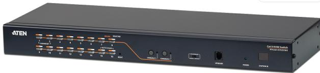
O comutador KVM KH2516A é uma unidade de controle que permite aos administradores de TI acessar e controlar diversos computadores a partir de dois consoles KVM PS/2 ou USB (dois bus). Operadores trabalhando em até dois consoles podem assumir o controle de até 16 computadores de modo independente e simultâneo. Conectando em série até 15 comutadores adicionais, é possível controlar até 256 computadores a partir do console KVM original.
