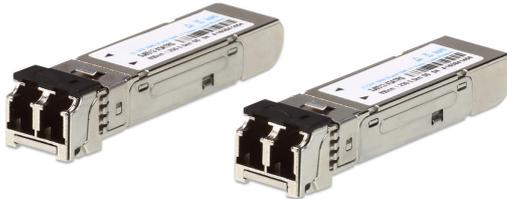
O Módulo Transceter Fibra Multi-Mode 1,25 G SFP 2A-136G proporciona conectividade 1 GbE até 550 metros. O transceter pode ser instalado em transmissores e recetores. Como módulo de ligação direta com conector duplo padrão, para comunicações fibra, o 2A-136G funciona com ligações multi-mods-fiber (MMF) e trabalha num comprimento de onda nominal de 850 nm, tornando-o um transceter económico e de alto desempenho.
