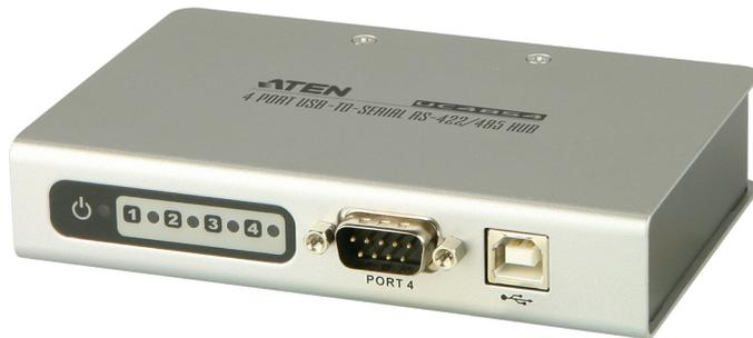
O Hub ATEN USB para Serial RS-422/485 oferece uma conexão serial plug-and-play externa RS-422 / RS-485 para computadores, notebooks, laptops e handheld (dispositivos portáteis) que suportam a especificação USB. Ele oferece uma solução rápida, simples e com baixo custo e é ideal para diferentes aplicações para comunicação e automação.
