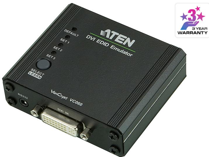
ATEN VC060 является DVI эмулятором, который предназначен для эмуляции и хранения данных EDID любого монитора, обеспечивая постоянный и надежный обмен характеристиками между DVI источником и монитором для оптимизации изображения.
