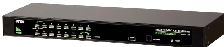
KVM-переключатель CS1316 – устройство управления, обеспечивающее доступ к 256 компьютерам с одной консоли (клавиатура, монитор и мышь). В каскад можно добавить 16 переключателей, что позволяет управлять 256 компьютерами с единой KVM-консоли. Поддерживаются соединения по интерфейсам USB и PS/2, как для консоли, так и компьютеров.
