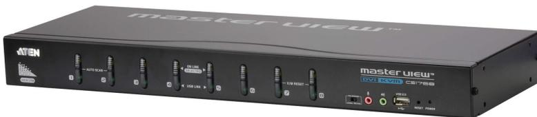
8-портовый KVM-переключатель USB DVI CS1768 представляет собой многоцелевое устройство, обеспечивающее подключение и управление 8 компьютерами с помощью консоли, оснащаемой одной клавиатурой USB, мышью USB и двумя мониторами (DVI-I и VGA).
