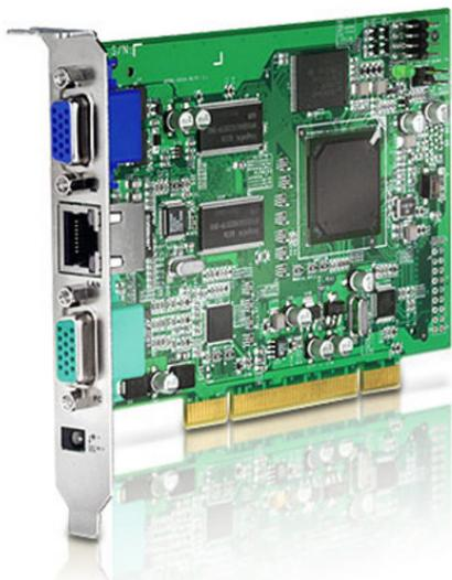
Карта PCI IP8000 - это устройство управления, обеспечивающее доступ по IP (over-IP) и управление сервером, на котором она установлена. Она поддерживает многоплатформенный доступ и управление сервером на расстоянии с помощью стандартного Интернет-браузера или отдельных приложений Windows и Java
