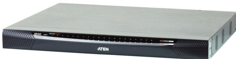
Четвертое поколение KVM-коммутаторов с доступом по IP компании ATEN превосходит ожидания. Модель KN4140VA обладает превосходным качеством видео (разрешение HD 1920 x 1200), стандартом безопасности FIPS 140-2 с уровнем 1 и вдвое большей скоростью передачи для устройств виртуальной среды.
