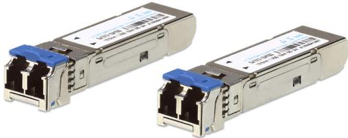
Одномодовый оптоволоконный модуль 2A-137G 1.25G SFP позволяет осуществить подключение 1 GbE на расстоянии до 10 километров и выполняет функции как передатчика, так и приемника. Обладая возможностью горячей замены и стандартным дуплексным разъемом для оптоволоконной связи, модуль 2A-137G работает по одномодовым оптоволоконным (SMF) соединениям с номинальной длиной волны 1310 нм, что делает его рентабельным и высокопроизводительным приемопередатчиком.
