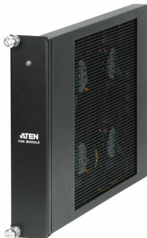
Перегрев значительно замедляет производительность устройства и может привести к выходу из строя оборудования во время работы. Матричный коммутатор [VM1600](#) оснащен вентиляторным модулем, обеспечивающим охлаждение системы и защищающим устройство от перегрева. Вентилятор обладает возможностью «горячей замены» (hot-plug), что позволяет легко выполнить замену без выключения всей системы. Компания ATEN гарантирует, что ваши инвестиции защищены, создавая при этом высокую производительность.
