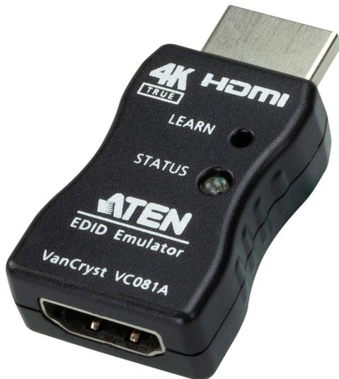
Устройство VC081A, является адаптером-эмулятором EDID для True 4K HDMI, и предназначено для эмуляции и сохранения одного набора EDID из подключенного дисплея, облегчая передачу 4K-видеосигнала. Изучая EDID-данные, выдаваемые HDMI-дисплеем и передавая их источнику видеосигнала, адаптер-эмулятор VC081A помогает устранить проблемы при процессе передачи видеоинформации, возникающие в случае неправильной синхронизации данных EDID между источником видеосигнала и подключенным HDMI-дисплеем.
