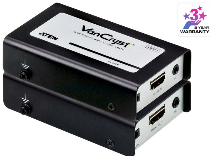
Удлинитель HDMI VE810 позволяет увеличить расстояние между дисплеем и источником HDMI до 60 м при помощи двух кабелей Cat 5e. Кроме того, VE810 оснащен функцией передачи ИК-сигналов, что позволяет использовать ИК-канал для управления источником HDMI с удаленного модуля или дисплеем – с локального модуля.
