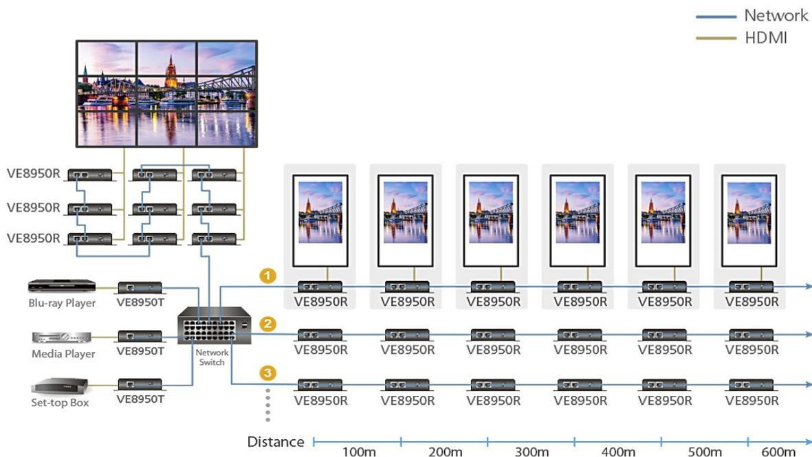
\*Использование подключения в цепь для создания видеостены или расширения аудио/видео систем на сотни метров
