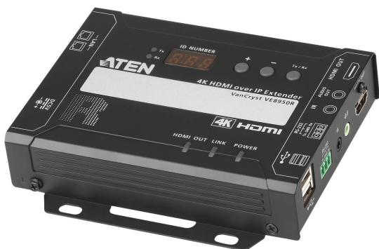
Приемник видеозображения по IP-подключению VE8950R компании ATEN может принимать на больших расстояниях, с низкой задержкой и без потерь в визуализации, аудио и видеосигналы уровня 4K, используя для этого локальную сеть на базе стандартного гигабитного сетевого коммутатора.\*
