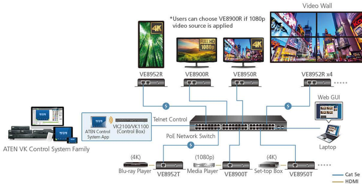
\*Obs! VE8952 stöder PoE och kan installeras i kombination med PoE-nätverksswitchar för att minska mängden nätströmskablar och ytterligare eluttag. Innan du väljer nätverksswitch och installation, se Implementeringsguiden.
