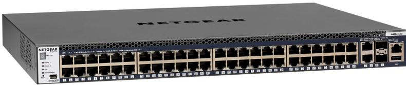
M4300-52G 擁有48個1G RJ45 + 2個10G RJ45 + 2個SFP+網路埠口，讓中小企業可輕鬆建置高備援的小型骨幹網路或小型IP SAN網路，例如：光纖連接到需要高速頻寬的網路儲存，或使用RJ45線路連接多台伺服器，如此一來便可降低伺服器10G網路卡的採購成本。
