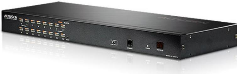
KH1516 Cat 5 KVM多電腦切換器可讓管理者透過單一控制端進行多台伺服器的管理與存取。KH1516 內建RJ-45介面，並採用Cat 5e/6線材連接伺服器，搭配先進的自動訊號增益功能 (Auto Signal Compensation, ASC)，視訊訊號傳輸距離可達40 公尺，並仍維持高品質的視訊解析度。透過PS/2或USB介面的電腦端模組，KH1516可支援PC、Mac、Sun平台、以及各種序列裝置。
