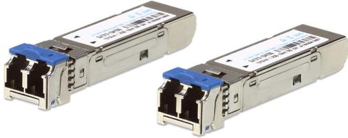
2A-137G 單模光纖1.25G SFP 收發模組提供距離達10 公里的1 GbE 連線能力，此收發器可安裝於傳送端與接收端，具備熱插拔及標準雙芯接頭設計，並支援1310 nm 波長的單模光纖（SMF）傳輸模式，可節省成本且發揮高效能。
