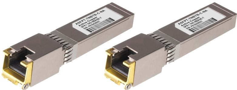
2A-145G 10Gb銅纜乙太網路 SFP 收發器專為高速乙太網路環境應用而設計，使用者可透過標準的Cat 6a/7 銅纜網路線提供穩定且可靠的連線。它可讓具備 SFP+ 連接埠的 [KG0016](#) / [KG0032](#) 與銅纜乙太網路設備連接，支援高達 10 Gbps 的資料傳輸速率與最遠 30 公尺的傳輸距離。2A-145G 具備高度彈性與易於部署的特性，是在資料中心或企業網路環境中最具成本效益、用於延伸 10GbE 高速連線的理想解決方案。
