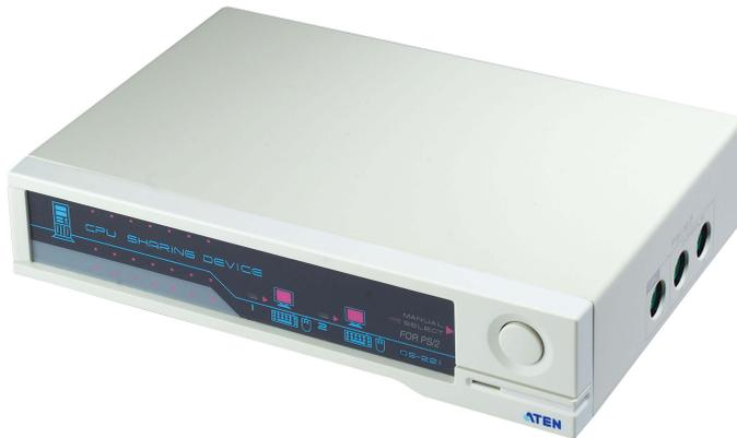
CS221 為電腦主機分享裝置,透過高效微處理器以控制電腦主機分享功能的裝置.此款多人單工裝置可讓兩位使用者從自己的控制端(螢幕,鍵盤和滑鼠)分享使用同一台電腦.此外,CS221支援PS/2介面控制端和電腦.
