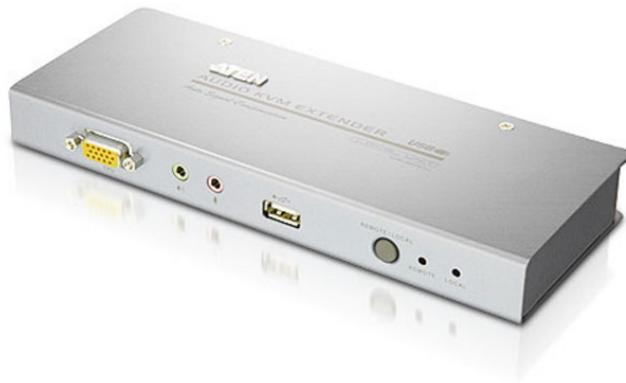
利用CE800即可透過近端控制端或最遠達250公尺 (825英尺) 的遠端控制端連結您的KVM多電腦切換器。CE800的近端和遠端裝置都支援USB控制端(螢幕、鍵盤與滑鼠)，同時，CE800還另外提供一個包含檔案分享保護功能的USB週邊連接埠，可用來與大量儲存裝置互傳檔案。
