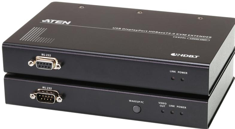
ATEN CE920 USB DisplayPort HDBaseT™ 2.0 KVM 訊號延長器整合最新的HDBaseT™ 2.0 技術，透過單一Cat6 或 [2L-2910](#) Cat6 線材，即可將4K 視訊、立體聲音訊、USB、乙太網路\* 和RS-232 訊號整合傳輸，並將傳輸距離延伸長達100 公尺。HDBaseT™ 2.0 提供目前市面上最可靠的整合式傳輸技術，並為CE920 帶來遠距離傳輸能力，可傳輸1080P 高畫質訊號長達150 公尺。CE920 的線材安裝簡易並支援各種訊號，特別適用於需要便利遠端存取的應用，例如交通控制中心、醫療院所、工業倉庫和延伸工作站等地。
