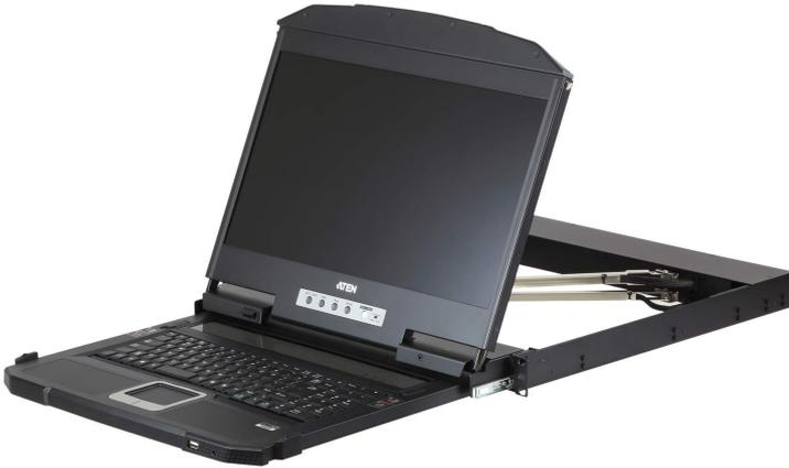
CL3800 USB HDMI DVI VGA LCD 控制端為一款雙滑軌LCD 控制設備，採用短機身外觀設計，將 18.5吋LED 背光模組技術的高畫質寬螢幕LCD 面板、鍵盤與滑鼠觸控板整合至抽拉式機體中。其短機身的設計適用於 19 吋及短機架深度設計的設備機櫃，尤其適合短機架。CL3800 不僅能節省寸土寸金的機房機架空間，亦可在空間有限的特殊環境中使用，例如戶外電視轉播車（outside broadcast vans；OB vans）及小型電腦控制室。
