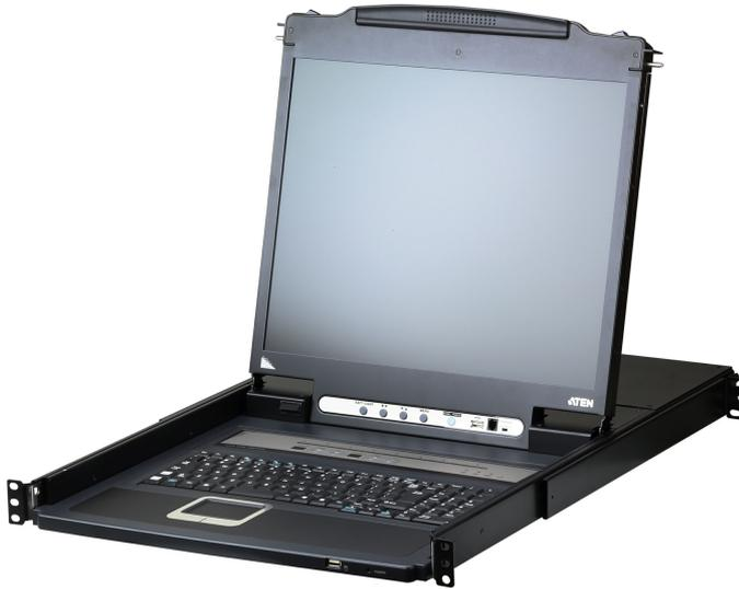
CL5708I Slideaway™ LCD KVM 抽拉式多電腦切換器是一套先進的控制方案，其可透過一組 PS/2或 USB KVM 控制端（鍵盤、螢幕及滑鼠）存取多台伺服器。一台 CL5708I 可直接管理 8 台伺服器；透過菊鍵方式，CL5708I可另外再串接 15 台 KVM 多電腦切換器，即可從單一控制端管理多達 128 台伺服器。
