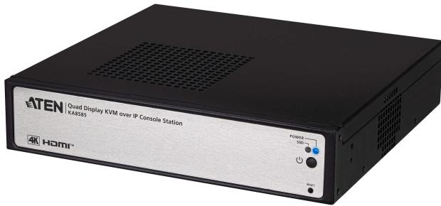
4K四螢幕KVM over IP控制台KA8585是一款高效能、全數位化的獨立式控制台，具備多畫面顯示 (Multi-view) 支援，可完全取代PC或筆電使用。其可接收來自KG / CN系列全數位KVM over IP切換器的4K影像，不會產生殘影或色彩暈染，讓使用者能遠端存取、監控並控制連接至多台KG系列 KVM over IP OmniBus Gateway與CN系列 KVM over IP切換器的所有伺服器。同時，KA8585提供進階多畫面顯示功能，可在四個顯示器上同時監控多個即時影像來源，並支援多種數據加密機制，以確保資料安全性無懈可擊。KA8585適用於任何需要即時存取與高度安全性的環境，是影像製作、金融產業、軟體開發與測試、辦公室、資料中心、廣播電台、控制室與網路操作中心 (NOC) 等應用的理想選擇。
