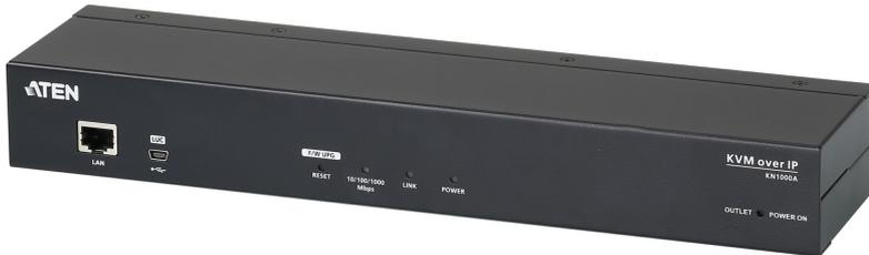
ATEN的新款單埠電源KVM over IP 切換器KN1000A可讓伺服器或未內建over IP 控管功能的傳統KVM 多電腦切換器擁有遠端控管的功能。其可讓操作者無須到場進行例行IT維修，即可從遠端使用瀏覽器、Windows或Java架構的應用程式監控及存取電腦，並支援至BIOS 層級的檢修故障。此外，若網路斷線，KN1000A可支援額外存取並有外部數據機備份資料。
