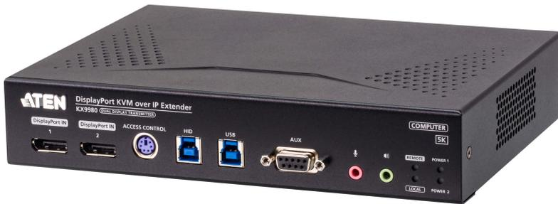
KX9980 5K DisplayPort 雙螢幕KVM over IP傳送裝置為一款高效能的IP架構的雙螢幕傳送裝置，傳送端可將電腦的鍵盤、視訊影像、滑鼠及USB訊號傳送至接收端，並於傳送端與接收端位置提供獨立的控制端存取。透過此建置，使用者可透過內部網路以KX9980R遠端直接存取電腦系統，因此，電腦主機能夠放置在安全且溫控的環境中，並與使用者工作站隔離。
