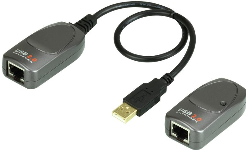
UCE260透過乙太網路線，可輕易地將USB訊號延伸至60公尺；此外傳輸速率最高達480Mb/s，並且向下相容至USB1.1(12Mb/s)及1.0(1.5Mb/s)裝置。無需任何設定及安裝驅動軟體，即可突破傳統USB的距離限制，延長USB周邊裝置或集線器與電腦之間的距離達60公尺(196英尺)。
