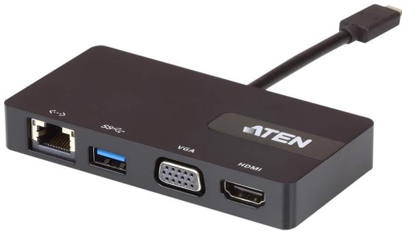
UH3232 USB-C 多埠迷你擴充基座可透過單一纜線連接乙太網路、HDMI、VGA 及USB Type-A 連接埠至搭載USB-C 連接埠的電腦。此四合一轉換器具整合及方便使用的特性，能夠立即連接您的USB-C 或Thunderbolt™ 3 電腦至HDMI 4K Ultra HD (3840 x 2160 @ 30 Hz) 或VGA 2K (2048 x 1152 @ 60 Hz) 視訊輸出、USB 3.1 Gen 1 連接埠及Gigabit 乙太網等快速對接。採用6 層PCBA 設計，能夠大幅降低信號干擾及失真的問題，使視頻能夠清晰不間斷，千兆乙太網可提供高達1000 Mbps 的網路速度。此方便又多用途的擴充基座提供最佳攜帶方案，可透過USB-C 電腦快速對接多種來源裝置。
