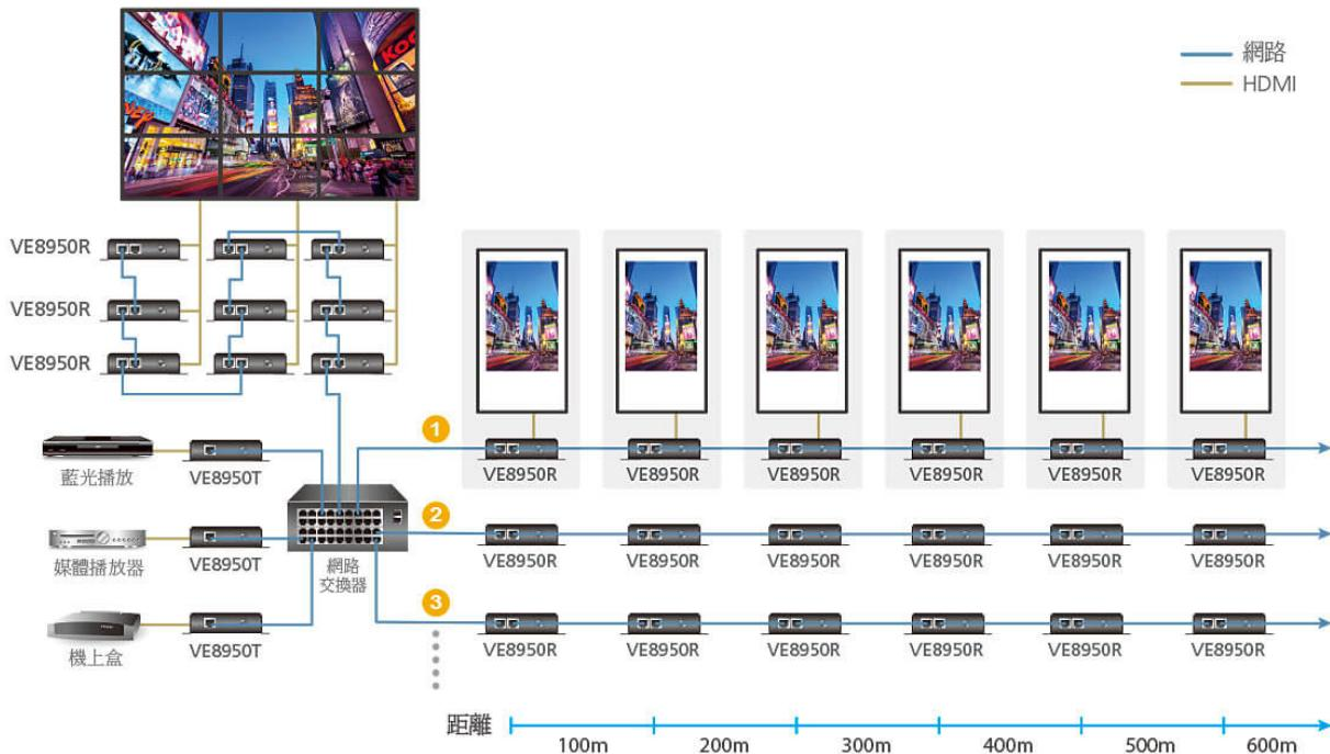
使用串接來設置視訊牆或延長影音系統達上百公尺
