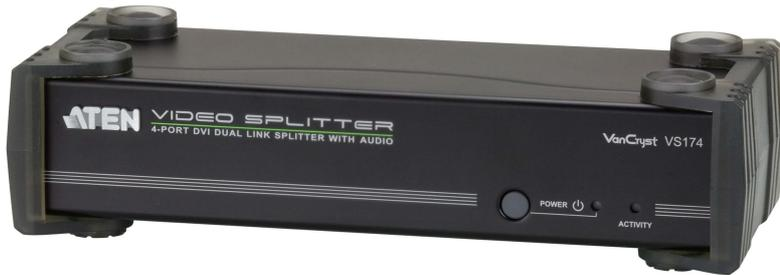
VS174 4埠DVI Dual Link視訊分配器+音訊功能結合DVI的視訊和音訊，將音訊/視訊訊號複製至4個音訊/視訊輸出埠。視訊分配器使用dual link技術，提供高頻寬效能為增加傳輸速率和更快的更新率及極佳的視訊解析度2560 x 1600。 [\[立即購買\]](#)
