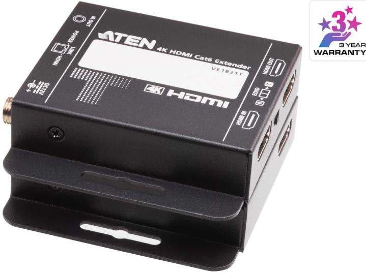
VE1821提供了完整的端到端解決方案，包含一個傳送器和一個接收器，透過一條Cat 6線（建議使用ATEN 自製線材\*）即可將 4096 x 2160 / 3840 x 2160 @ 30 Hz (4 : 4 : 4) 的 HDMI 訊號延長至 40 公尺遠處。VE1821可無延遲且無壓縮地傳輸4K訊源，確保了清晰的視訊品質。此外，亦支援LPCM 7.1CH、Dolby TrueHD、Dolby Digital Plus和DTS-HD Master Audio等無損音訊格式，帶給觀眾更優質的視訊體驗。
