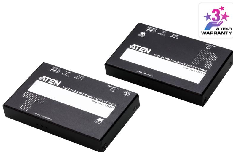
VE1830 是一款 True 4K HDMI HDBaseT-Lite 訊號延長器，整合 HDBaseT™ 技術，只需透過一條 Cat5e/6 線材，即能將 VE1830T 視訊傳送器與 VE1830R 視訊接收器間的 True 4K HDMI 訊號延伸長達 35 公尺，為專業影音安裝提供一個高品質且彈性易用的解決方案。此 True 4K HDMI HDBaseT-Lite 訊號延長器相容 HDCP 2.2，並支援 HDMI (3D、色深、4K)，能傳遞無失真的影音訊號。除此之外，VE1830 更支援 PoC (Power over Cable) 技術，可經由傳送器供應電源給接收器。VE1830 非常適合部署於數位教室、視訊會議室、家庭劇院或任何影音安裝架構中需要高視訊解析度品質的環境，為使用者提供一套簡單易用且具成本效益的專業級影音解決方案。
