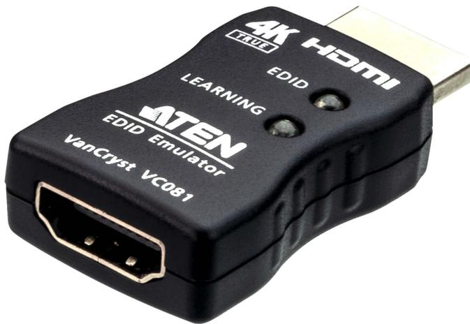
VC081 True 4K HDMI EDID 模擬器，可有效地幫助使用者解決在使用AV 或KVM 延伸器、切換器、分配器時所產生的EDID 相關問題。藉由載入指定 HDMI 顯示裝置的EDID 資料，並正確提供給來源設備，VC081 能解決影音設備整合時因EDID 對應不正確所造成的問題。除此之外，當顯示裝置的EDID 成功載入VC081 之後，此模擬器也可讓PC 或伺服器保持連線不中斷，使透過IP 進行的遠端連線更順暢。
