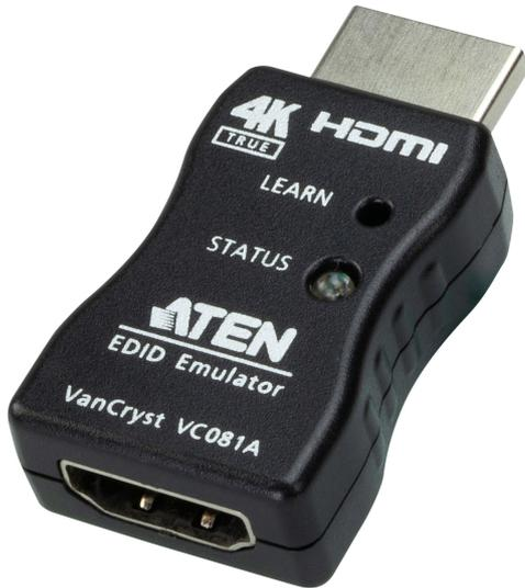
VC081A True 4K HDMI EDID模擬器可有效解決用戶在使用AV或KVM延伸器、切換器、分配器時所遇到的EDID相關問題，不僅能學習、模擬及儲存視訊顯示裝置的EDID數據，更提供穩定的4K影像傳輸，排除影音設備播放或安裝整合上因EDID錯誤而造成無法出畫或畫面閃爍等異常狀況。
