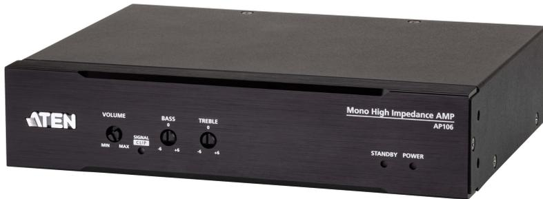
AP106 60W Mono定壓擴大機可為定壓70V / 100V音響系統提供單聲道60瓦功率。支援平衡與非平衡類比線路電平輸入，達到絕佳的音質與安裝彈性。使用者不僅可調整整體音量，更可透過2段式梳狀EQ等化器，將高、低音頻增強或削減6分貝。AP106有足夠的餘裕度，對於瞬間的高功率需求，仍能提供高保真的音色。
