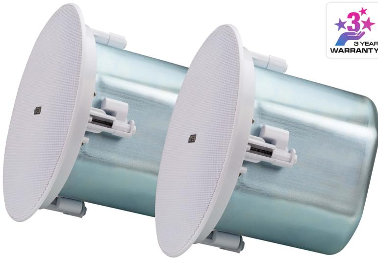
AS106 6.5"薄邊框同軸吸頂揚聲器採同軸雙音路設計，實現優異的聲學性能。每個揚聲器 搭載6.5"低音單體與20mm球形高音喇叭單體，額定電源達到輸出功率(RMS) 60 W，峰值音響功率120 W (8Ω)。頻率範圍80 - 20 kHz確保了一致的絕佳音質，而寬廣的覆蓋範圍更能將聲能均勻地覆蓋至揚聲器的全段頻率範圍，減少安裝區域所需的揚聲器數量，進而降低安裝成本。
