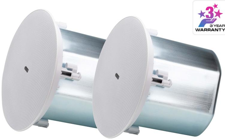
AS108 8" 薄邊框同軸吸頂揚聲器採同軸雙音路設計，實現優異的聲學性能。每個揚聲器搭載 8" 低音單體與 20 mm 球形高音喇叭單體，額定電源達到輸出功率 80 W，峰值音響功率 160 W (8Ω)。頻率範圍 65 - 20 kHz 確保了一致的絕佳音質，而寬廣的覆蓋範圍更能將聲能均勻地覆蓋至揚聲器的全段頻率範圍，減少安裝區域所需的揚聲器數量，進而降低安裝成本。
