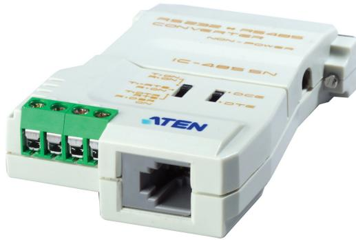
IC485SN 是一款信號雙向轉換器，可在 RS-232 與 RS-485 / RS-422 兩個信號中轉換，距離可達 1200 公尺，且無需外接電源。 [\[立即購買\]](#)
