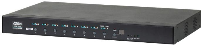
ATEN PE6108AV eco PDU電源分配器為支援8個AC插座的1U智慧型機架式電源分配器，相當適合ProAV 專業影音的應用。獨特的可拆式前面板讓使用更方便，可與各ProAV設備一同架設在不同深度的19吋機 櫃內。除了可透過LAN遠端控制個別插座，使用者也可利用前面板上的按鈕來控制插座，輕鬆在機櫃旁或從遠端關閉ProAV設備，以節省能源的消耗。插座循序開啟的功能，可確保穩定安全地開啟ProAV設備。此外，PE6108AV相容於ATEN環控系統及Control4資料庫，不需具備複雜的程式設計知識即可與任何ProAV設備整合，全面管控所有的裝置。
