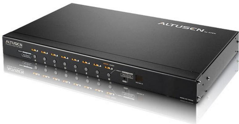
ALTUSEN PN9108是創新的遠端電源管理方案,其能透過TCP/IP連線管理遠端8台裝置的電源。無論是在大樓內或全球任何地方,管理者或使用者都能從國際網路連結的任何一台電腦開啟,關閉或重新啟動PN9108連接的任何裝置。PN9108擁有先進的功能及簡單的操作方式,是從遠端連線至機房最方便,可靠與符合成本效益的選擇。
